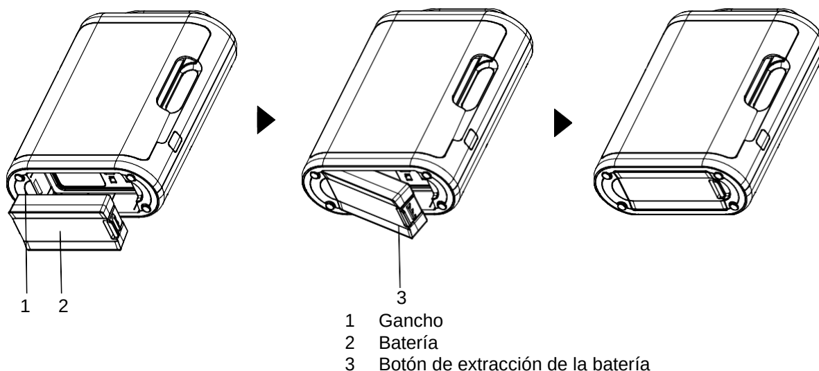
Figura 4. Instalación de la batería
