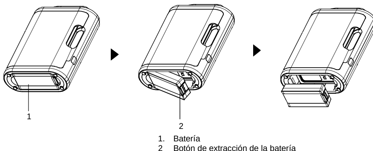
Figura 3. Extracción de la batería
